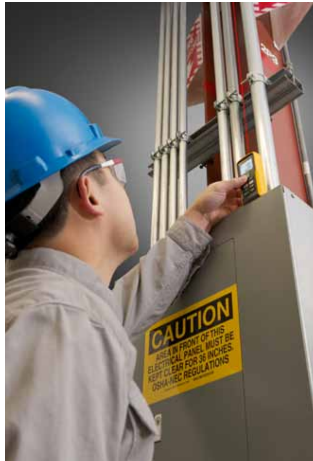
Messen der Höhe hoher Decken
